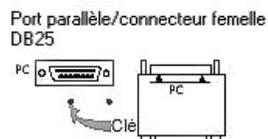
Si vous devez utiliser une imprimante sur ce port parallèle, connectez-la simplement à la clé de protection logicielle. Dans ce cas, vous devez mettre l'imprimante sous tension pour permettre la reconnaissance de la clé de protection logicielle.
