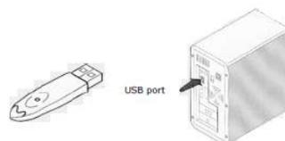
Si vous utilisez une clé USB et disposez de plusieurs ports USB, le port utilisé n'a pas d'importance. Si vous n'avez pas de port USB disponible, vous pouvez utiliser un hub USB. Les clés USB peuvent être branchées et débranchées au port à tout moment, sans avoir besoin de redémarrer l'ordinateur.
